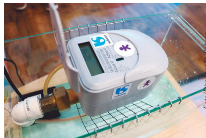
Novo hidrômetro inteligente que será instalado nas residências
