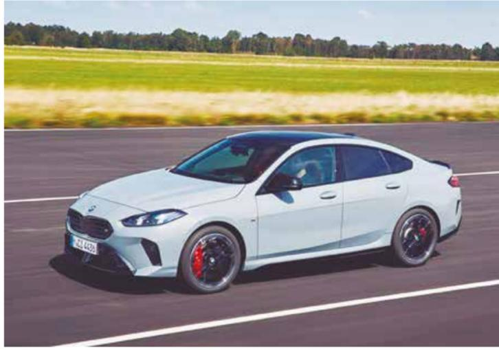
Versão esportiva, o BMW M235 xDrive é equipado com um motor de quatro cilindros TwinPower Turbo de 317 cv e 400 Nm de torque. A transmissão Steptronic tem 7 velocidades e dupla embreagem. Com esse conjunto, o modelo acelera de 0 a 100 km/h em apenas 4,9 s.
