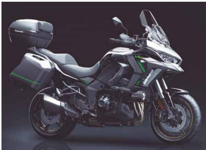
com tecnologia Skyhook da Showa, que ajusta o amortecimento em tempo real com base em sensores de curso, IMU (Unidade de Medição Inercial) e velocidade. O conjunto garante controle e estabilidade em curvas, suavidade sobre irregularidades, conforto em viagens longas e total comodidade na utilização, comandadas via punho esquerdo.
