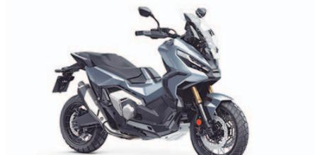
discos de 296 mm de diâmetro na dianteira, atrás o disco tem 240 mm com câliper de pistão simples.
