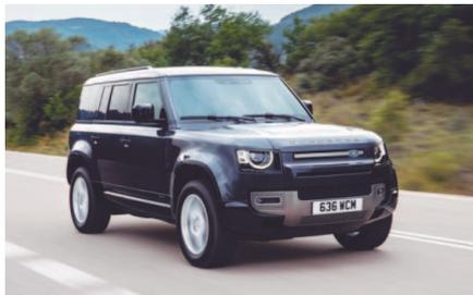
situações extremas. Construída com um monobloco leve e forte de alumínio, corresponde à carroceria mais resistente que a Land Rover já produziu. Ela é dez vezes mais rígida do que o Defender anterior, fornecendo bases perfeitas para suspensão totalmente independente.
