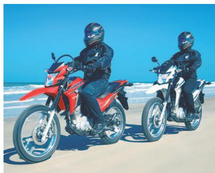
180 mm para a roda calçada com pneu medida 90/90-19 M/C 52P. Além disso, a suspensão é do tipo monoamortecida, com conjunto mola-amortecedor acoplado diretamente à balança de aço, que permite à roda, calçada com pneu 110/90-17 M/C 60P, curso de 150 mm.
