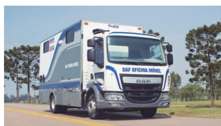
O caminhão LF, que serve como base para o serviço, contará com equipamentos como: bancada de trabalho com ferramentas elétricas e pneumáticas, carrinho de ferramentas, equipamento de diagnóstico para veículos DAF, talha para auxílio de carregamento, mangueiras de abastecimento com controle de vazão para lubrificantes, gerador e compressor de ar.
