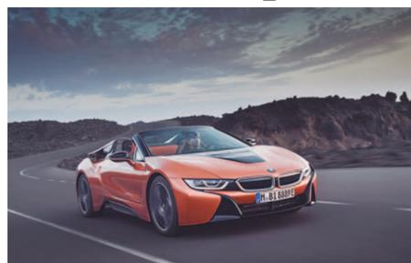
nos de fibra de carbono e cerâmica, head-up display com luz indicadora para troca de marchas (shift-light) e rodas de 20 polegadas. No caso do Roadster, o teto retrátil é estendido ou recolhido em apenas 15 segundos e funciona em velocidade até 50 km/h.
