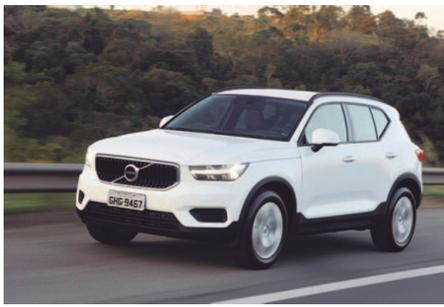
tem incorpora aos faróis do veículo as funções de nivelamento automático de acordo com a carga do carro; Active High Beam (AHB), com sistema automático que adapta a luz alta para evitar o ofuscamento em outros veículos; e Daytime Running Lights (DRL) com acendimento automático, no qual a luz diurna em formato "T" (Martelo de Thor) contribui para a visualização do veículo, mesmo em dias muito claros.
