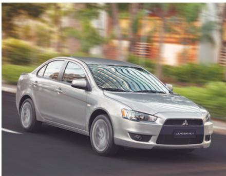
A estrutura da carroceria foi construída sob o conceito RISE de deformação controlada e o veículo é equipado com barras de proteção lateral nas quatro portas, bancos dianteiros com apoios de cabeça para proteção contra o efeito chicote, coluna de direção colapsável, cintos de segurança com pré-tensionador e limitador de força.
