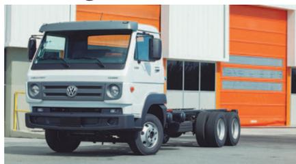
O Delivery 13.160 está com uma plataforma de carga ampliada, vantagem percebida especialmente pelos clientes que transportam materiais volumosos. O novo entre-eixos do modelo é de 3.300 mm, ou seja, 15% maior que na versão anterior e atende aos parâmetros atuais da legislação para Veículo Urbano de Carga (VUC) na cidade de São Paulo. Entre seus atributos, o veículo tem Peso Bruto Total (PBT) de 13,2 toneladas, o maior da categoria, e vem com o terceiro eixo de fábrica, com garantia da montadora.
